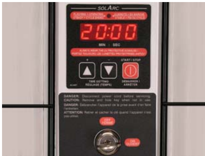
El temporizador digital e interruptor son características de seguridad importantes
